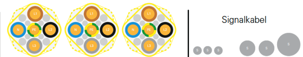
EMV-mässig ideale Anordnung durch Verwendung von mehradrigen symmetrischen Kabeln Abbildung 32
