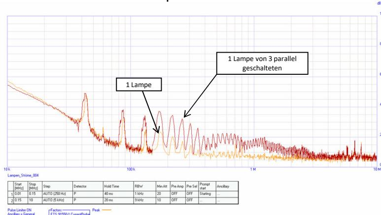
Strommessungen mit HF-Stromwandler
