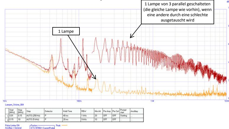
Strommessungen mit HF-Stromwandler
