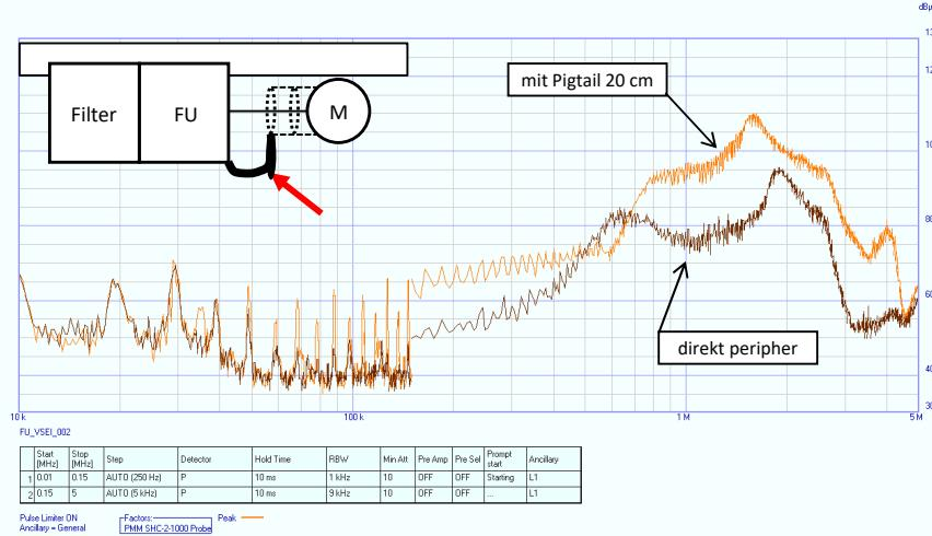
Kontaktierung des Motorkabelschirms mit „Pigtail“ oder direkt peripher an FU-Gehäuse
