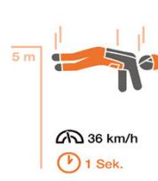
Bei einer Sturzhöhe von 5 Metern beträgt die Sturzzeit 1 Sekunde und die Aufprallgeschwindigkeit 36 km/h.
