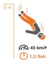
Bei einer Sturzhöhe von 8 Metern beträgt die Sturzzeit 1,3 Sekunden und die Aufprallgeschwindigkeit 45 km/h.
