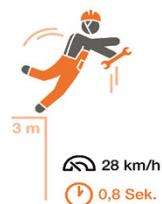
Bei einer Sturzhöhe von nur 3 Metern beträgt die Sturzzeit 0,8 Sekunden und die Aufprallgeschwindigkeit 28 km/h. Schon bei geringer Höhe kann ein Absturz tödlich sein.
